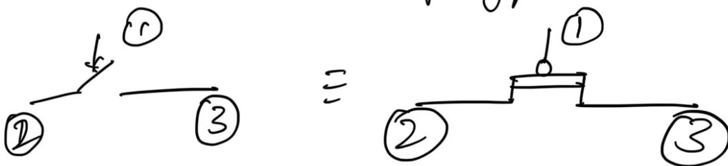
ON iff  $V_{1-2,3} < V_{th}$
